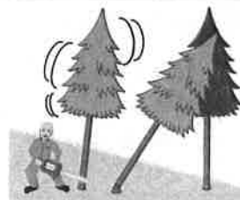
(図4)かかり木に激突させるためにかかり木以外立木の伐倒
