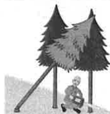
(図3)かかっている立木の伐倒
