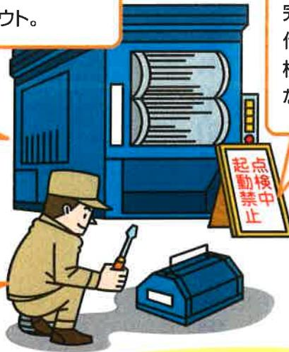
動力を遮断し（電源を切り）、機械設備を完全に停止させ、操作盤等の近くに「点検中のため起動厳禁」などの表示をする。
